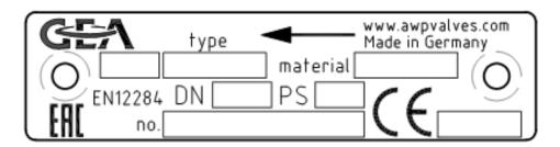
PS [bar] - maximal zulässiger Betriebsüberdruck permissible working pressure
