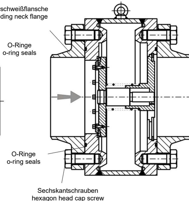
Vor Einbau der Ventile sind Rohrleitungen und Anlagenteile zu säubern. Das Ausblasen der Rohrleitungen nach Einbau der Ventile kann zur Beschädigung des Teflon-Flachdichttringes am Ventilteller führen und ist unzulässig.
